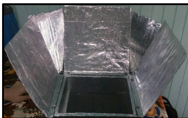
Figura 4 – utilização de abas moveáveis no forno solar construído pelo grupo G2 .
