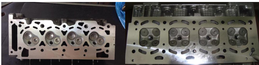
Figura 1 – Comparação entre dois cabeçotes, um com oito válvulas (à esquerda) e outro com dezesseis válvulas (à direita).
