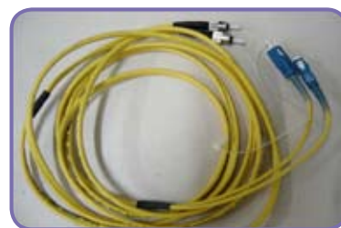
Figura C.14 - fibra ótica montada em cabo com conector ST.
