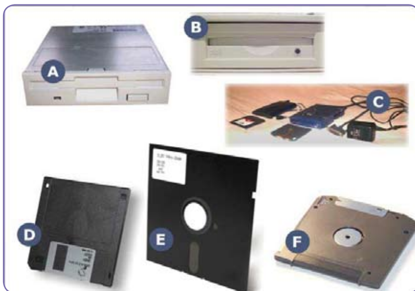
Figura A.12- A) drive de disquete de 3 1/2" , B) zip-drive interno de 3 1/2" ,C) zip-drive externo, D) disquete de 3 1/2" 1.44MB, E) disquete de 5 1/4" 360KB, F) disquete zip 100MB (Fonte: ver lista de créditos de imagens 05).
