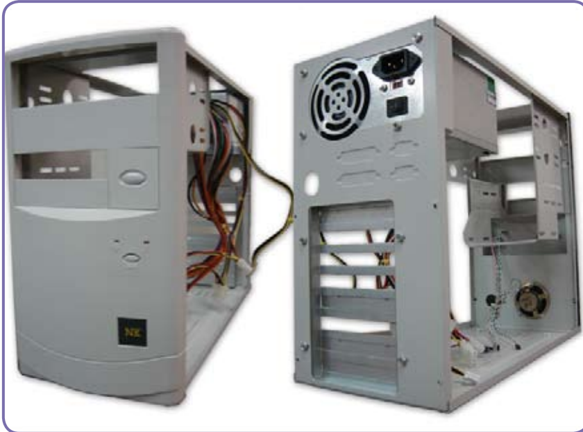
Figura A.5 - Gabinete de computador: visão frontal e interna de um gabinete (Fonte: ver lista de créditos de imagens 01).
