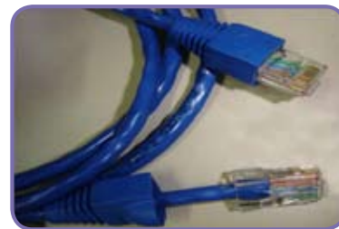
Figura C.13 - a) cabo par trançado UTP 4 pares, visão do conector RJ45 instalado no cabo com e sem protetor plástico.
