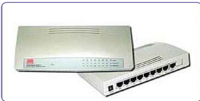
Figura C.15 - Exemplo de um HUB de 8 portas (Fonte: ver lista de créditos de
