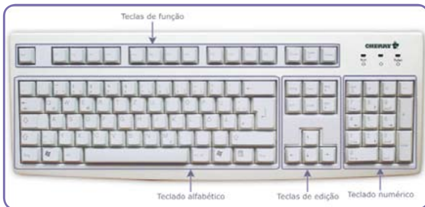
Figura A.19 - Teclado de computador destacando: teclado numérico, teclado alfabético, teclas de edição e de função (Fonte: ver lista de créditos de imagens 10).
