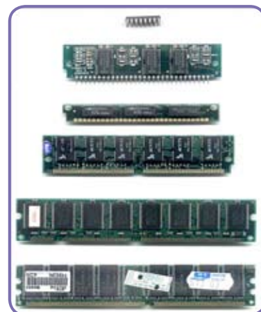
Figura A.10 - Modelos de memória principal com diferentes encapsulamentos (Fonte: ver lista de créditos de imagens 03).
