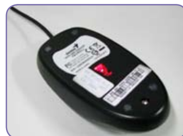
Figura A.22 - Vista inferior de um mouse óptico, a luz vermelha é o laser acionado.
