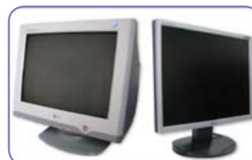
Figura A.23 - À esquerda monitor TRC, à direita monitor LCD.
