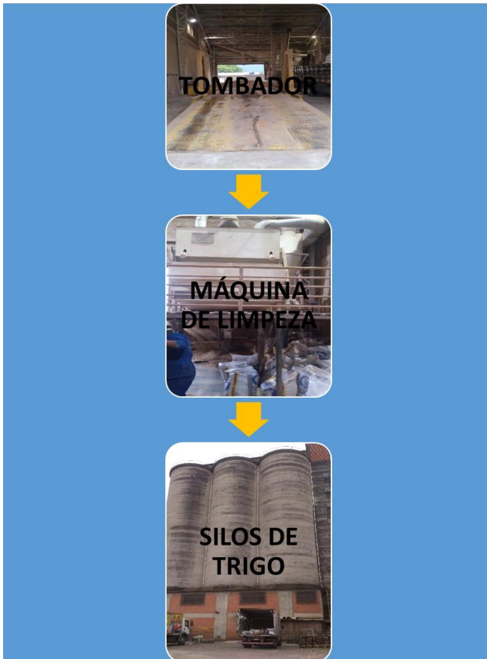
Figura 7 – Circuito da recepção de trigo Fonte: Dados da pesquisa (2015).
