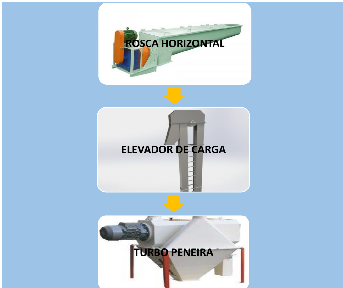
Figura 22 – Circuito de habilitação do silo de farinha Fonte: Dados da pesquisa (2015).
