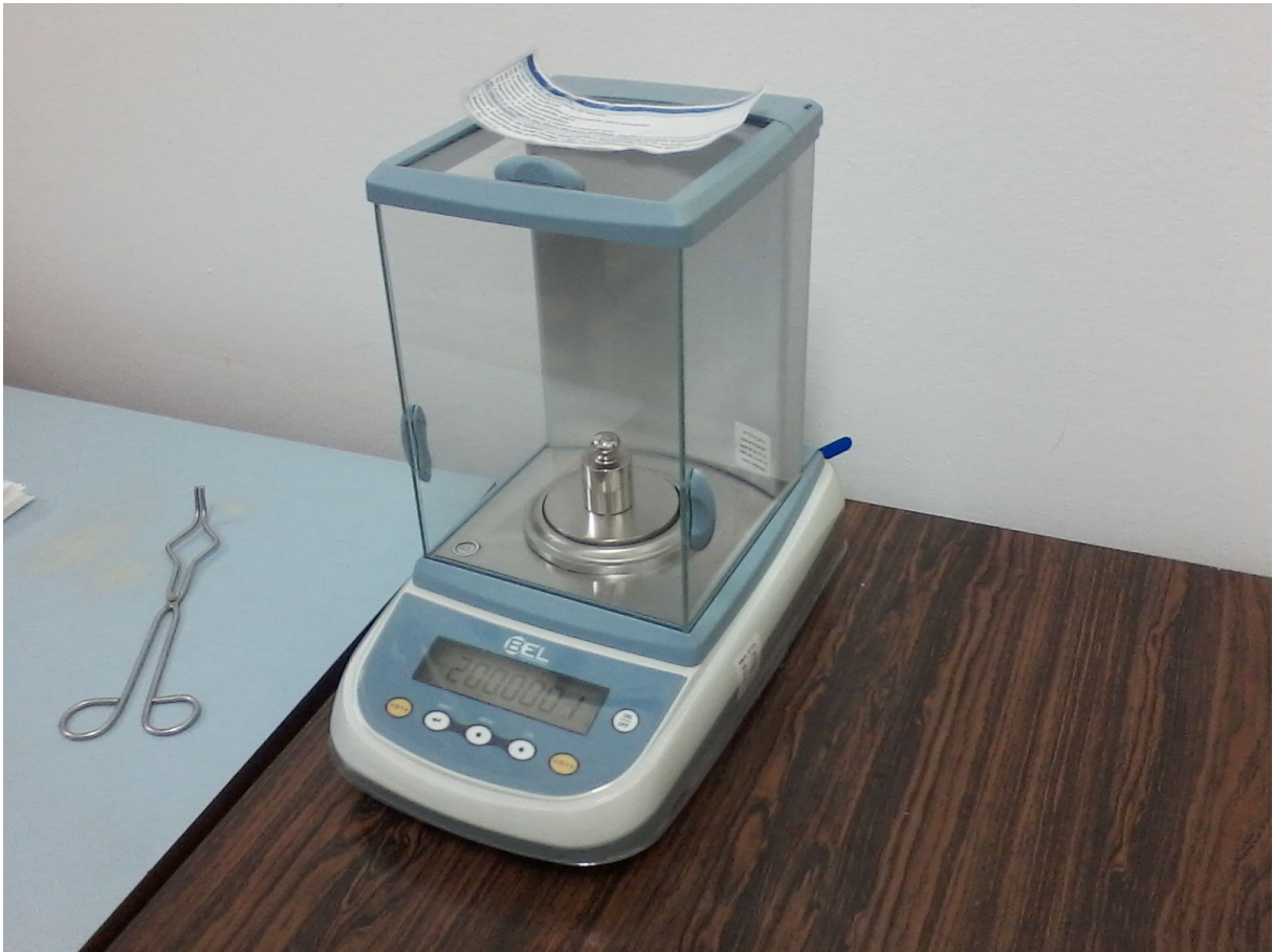
Figura 14 - Balança analítica de alta precisão utilizada para pesagem dos filtros de celulose.
