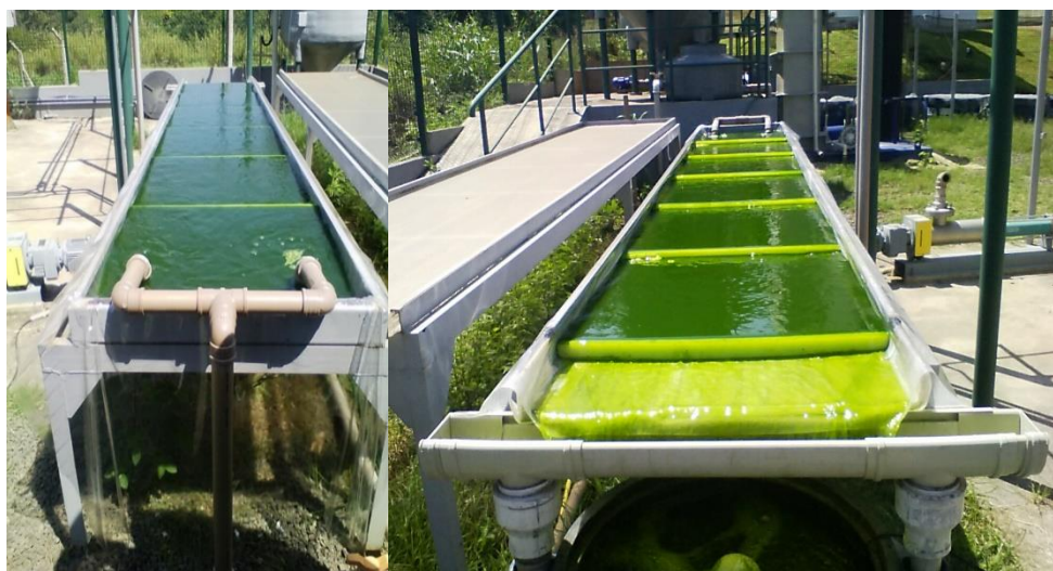
Figura 3 – Fotobiorreator híbrido em escala piloto em operação. (ALGAE Biotecnologia Ltda., Piracicaba – SP).
