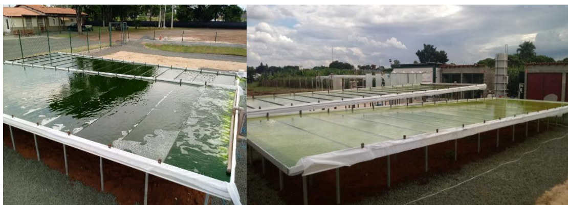
Figura 8 – Fotobiorreator híbrido escala industrial em operação. (ALGAE Biotecnologia Ltda., Holambra – SP).
