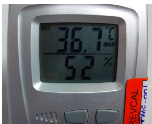
Figura 42 - Temperatura máxima do dissipador durante os ensaios de eficiência CEC
