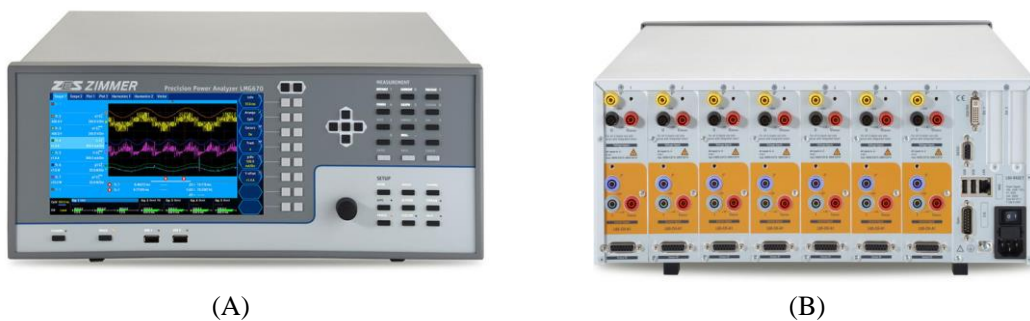
Figura 16 - ZIMMER LMG 670: (A) Vista frontal; (B) Vista traseira, mostrando os canais
