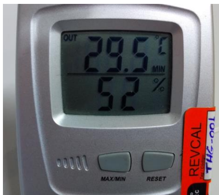
Figura 41 - Temperatura mínima do dissipador durante os ensaios de eficiência CEC
