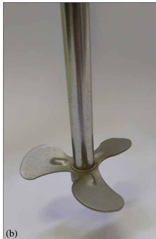
Figura 14 - (a) Unidade de agregação de mistura completa equipada com um agitador mecânico, da marca Fisatom, modelo 715, rotação de 120 a 2000 rpm e 70 W de potência. (b) Hélice naval.
