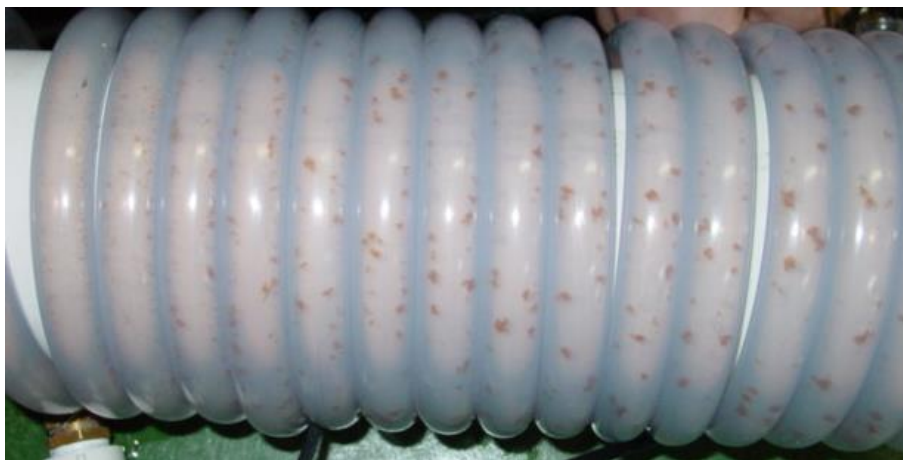
Figura 13 - Formação de flocos no Floclador Tubular Helicoidal.
