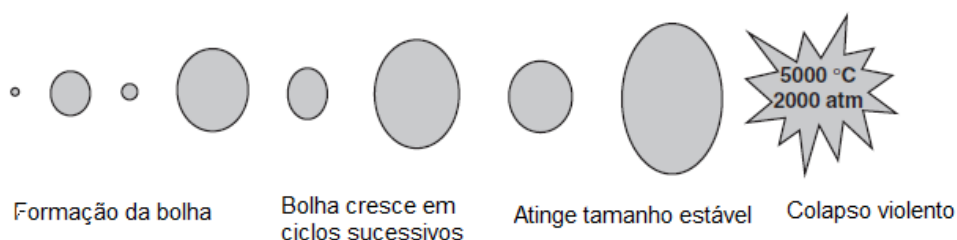
Figura 9: Representação do desenvolvimento e colapso de bolhas de cavitação
