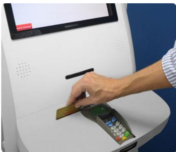
Figura 7 - Terminal de acesso com sistema de pagamento com cartão de débito.
