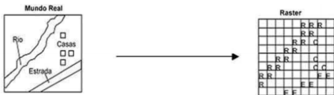
Figura 1 – Representação de um mapa do mundo real através de estrutura matricial ou raster.
