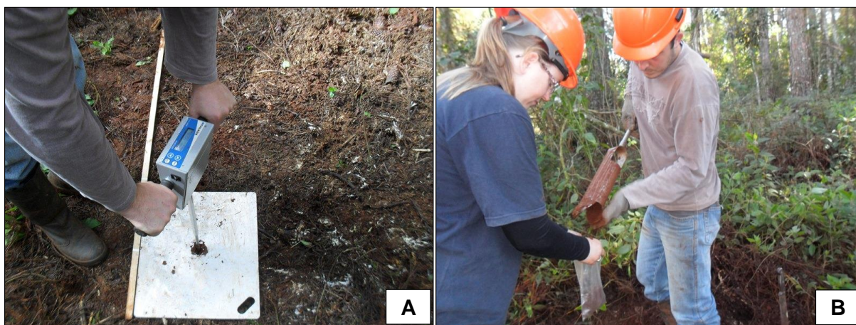
Figura 11 - Medição da resistência do solo à penetração (A) e coleta de amostras de solo para umidade (B).
