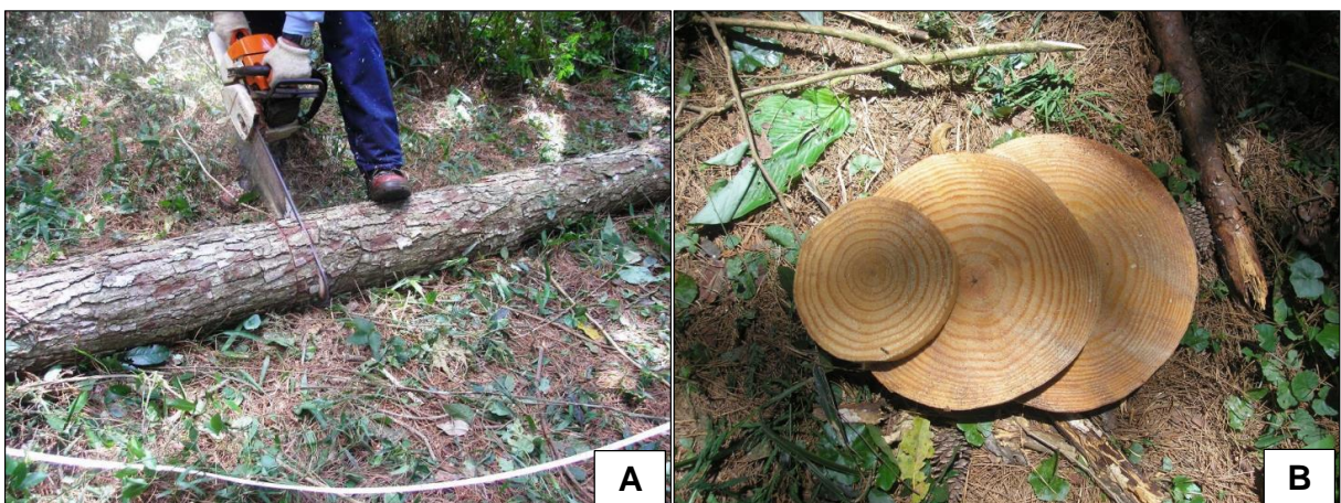
Figura 7 - A) Corte dos discos do fuste. B) Detalhe dos discos sem casca.
