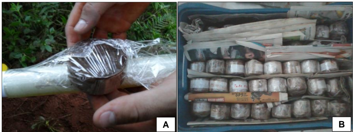
Figura 10 - Coleta de amostras de solo. Em A) cilindro metálico com solo em estrutura preservada e; B) acondicionamento para transporte.
