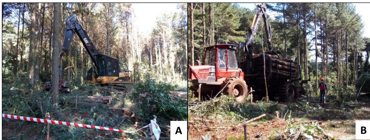
Figura 2 - Máquinas utilizadas na colheita florestal. A) harvester e B) forwarder .
