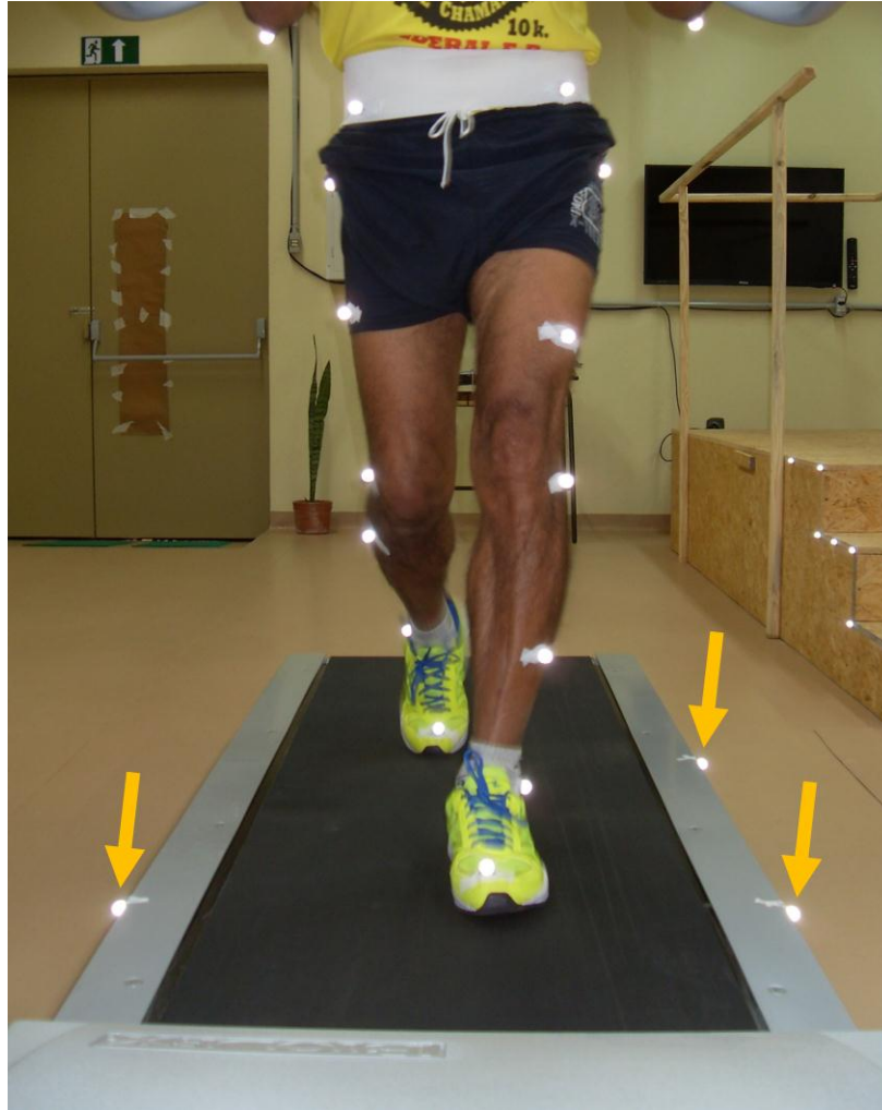
Figura 6 - Posição dos marcadores na esteira. Setas indicam os 3 marcadores utilizados para coletar as informações cinemáticas da posição espacial da esteira.
