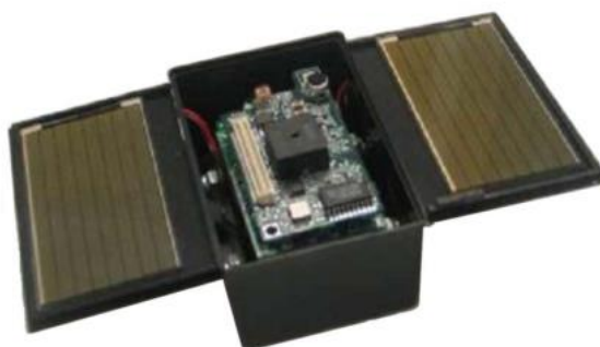
Figura 4: Sistema de EH compacto para alimentar nó de uma rede de sensores sem fio. Fonte: Raghunathan et al., (2005, p. 460)
