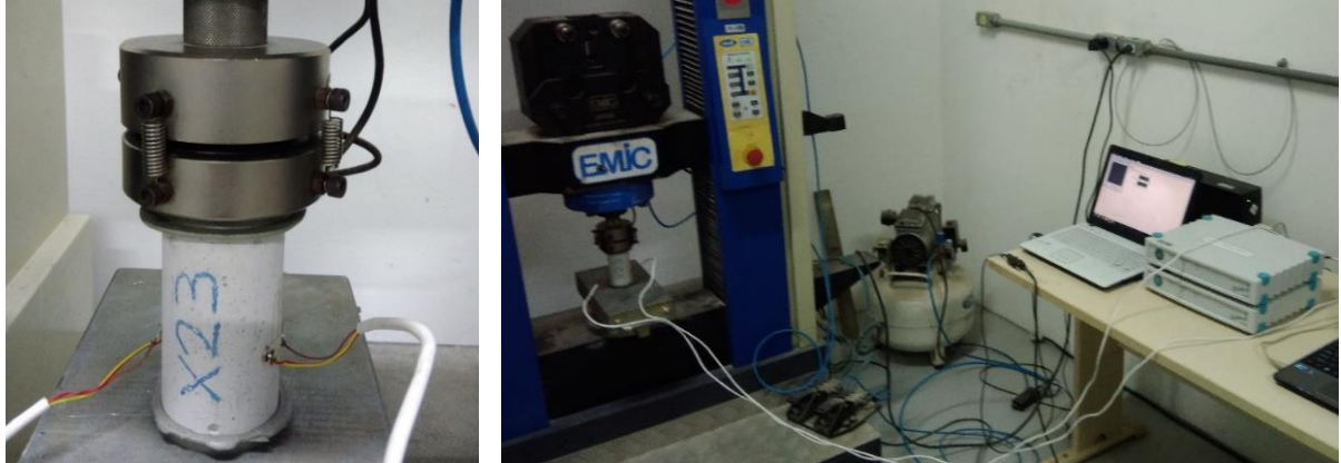
Figura 31 – Ensaio de compressão de corpo de prova de argamassa cilíndrico de dimensões \phi 5 cm x 10 cm, instrumentado.
