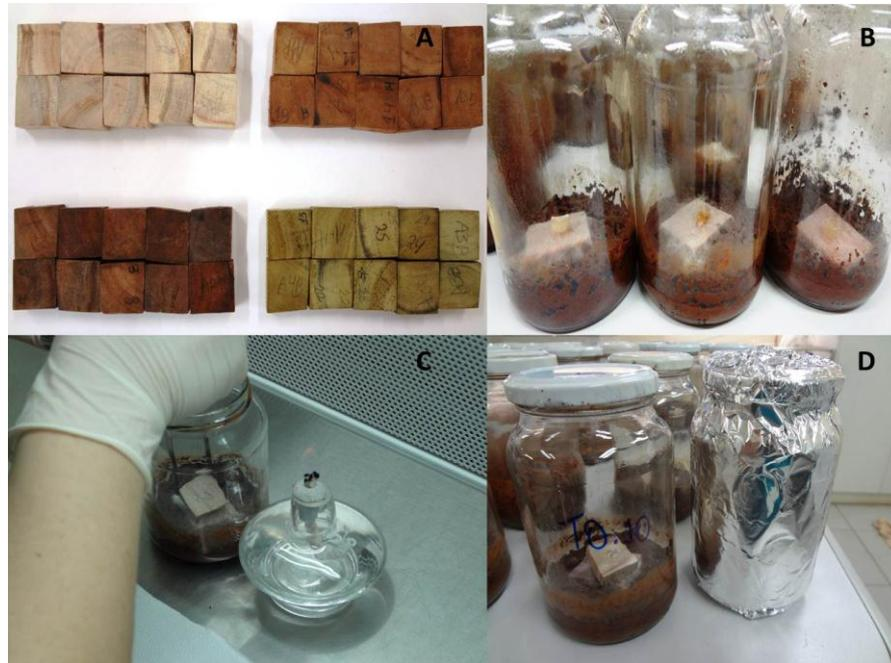
Figura 5 - Material pronto para o ensaio (A) placa colonizadora completa (B) transferência corpos de prova (C) vidros embalados para armazenamento (D).
