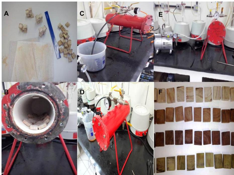
Figura 3 - Preparo e seleção dos corpos de prova (A) disposição do material na autoclave (B) adição do produto: tanino (C) mistura CCB (D) período de pressão (E) corpos de prova após tratamento.
