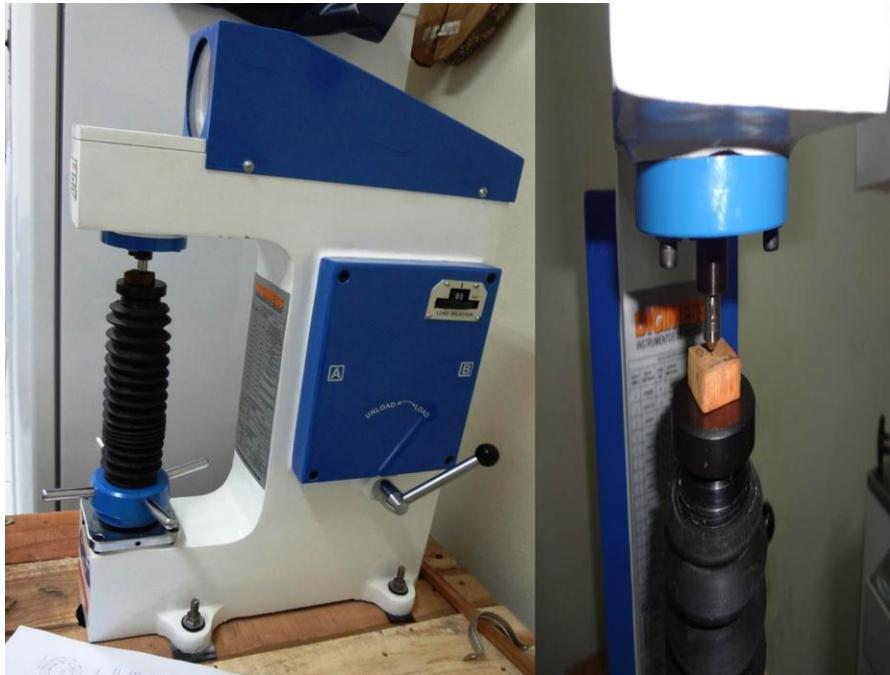
Figura 10 - Equipamento medidor de dureza Rockwell.
