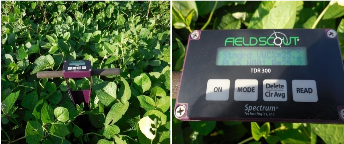
Figura 2 - Leitura dos valores de constante dielétrica pelo TDR 300. Santa Maria, RS, 2015.
