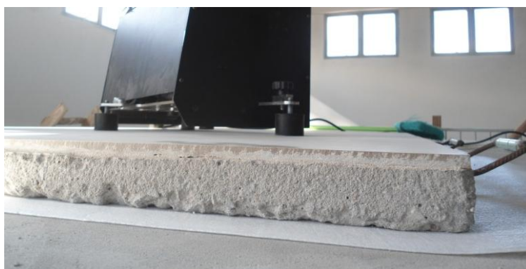
Figura 3.5 - Manta de polipropileno expandido 2 mm sob contrapiso
