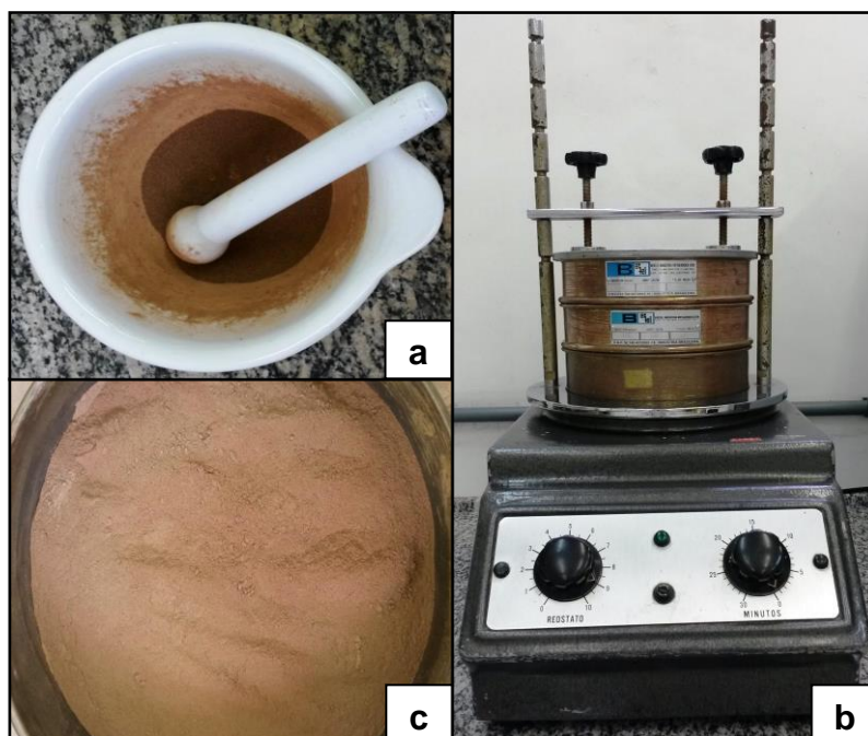
Figura 3. Pré-tratamento das amostras de solo e sedimento. a) Cominuição em gral de porcelana, (b) peneiramento em tamisador e (c) aspecto da amostra após passar pela etapa de peneiramento.
