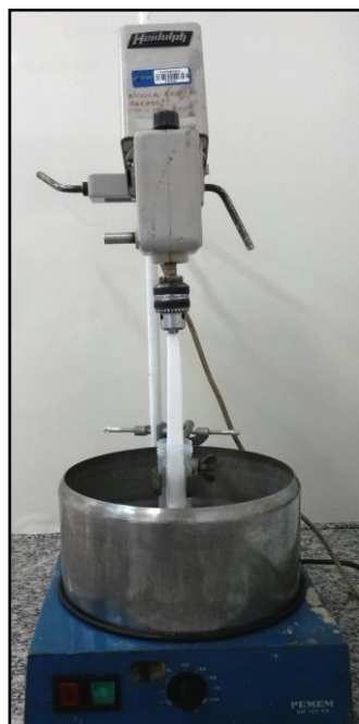
Figura 34. Sistema de agitação mecânica utilizado para extração de As, Cd, Cr, Ni e Pb em solo e sedimento para fins de comparação com a extração assistida por ultrassom.
