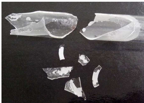
Figura 52. Danos no tubo de quartzo após a decomposição do solo “C1” por QTC-P.
