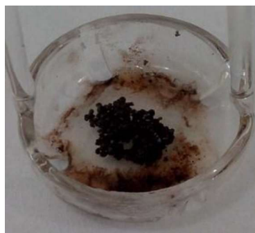
Figura 19. Aspecto do comprimido da amostra obtido após a decomposição por MIC de 100 mg do solo “B3” com 100 mg de celulose microcristalina (sem etapa de refluxo).
