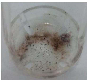
Figura 23. Aspecto da base do suporte obtido após a decomposição por MIC de 100 mg do solo “C2” com 400 mg de celulose microcristalina (sem etapa de refluxo).
