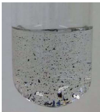
Figura 13. Aspecto da solução após a decomposição de 200 mg de óleo mineral por MIC.
