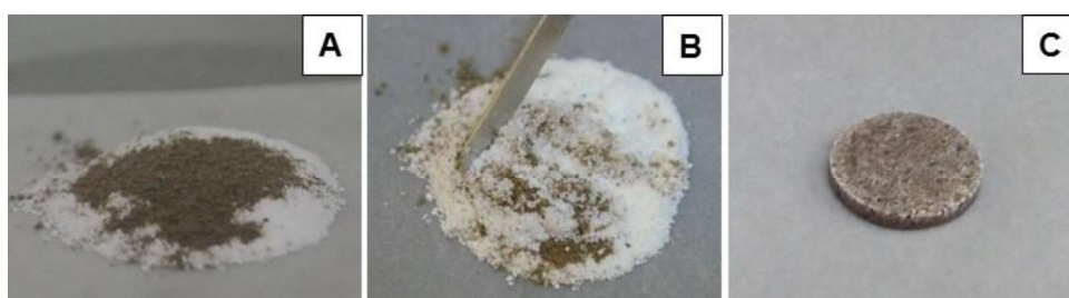
Figura 3. Etapas envolvidas na formação dos comprimidos do solo misturado com celulose: A) pesagem do solo e da celulose, B) mistura do solo e da celulose com auxílio de uma espátula e C) comprimido formado após prensagem.
