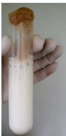
Figura 34. Formação de espuma após a adição de 550 µL de NH 4 OH 14,8 mol L -1 no frasco contendo 100 mg do solo “A1” e 8 mL de H 2 O 2 50%.
