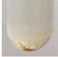
Figura 35. Aspecto do digerido após a decomposição do solo “A1” por MAWD-SRC, na temperatura de 225 °C.
