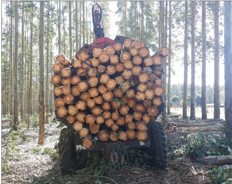
Figura 17 – Representação do baldeio com carga completa
