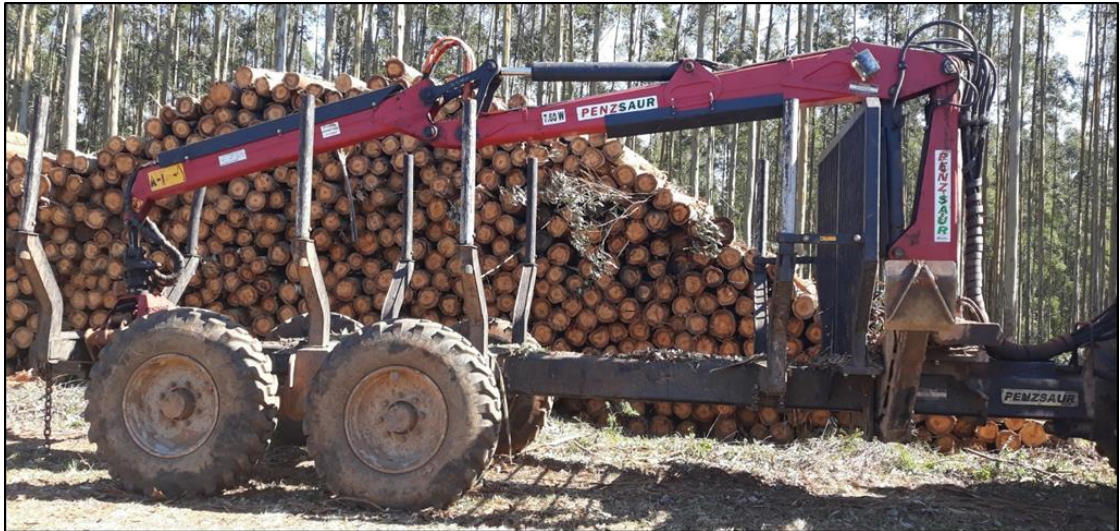
Figura 16 – Reboque com grua da fabricante Pensaur
