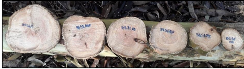
Figura 12 – Discos para determinação da densidade da madeira
