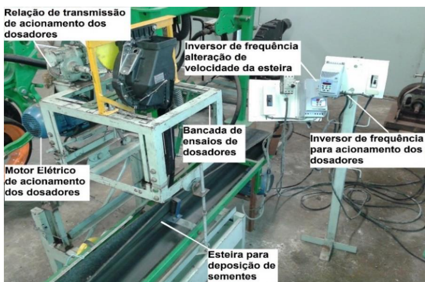
Figura 8 - Bancada de ensaio de doadores de sementes (BEDOSA)
