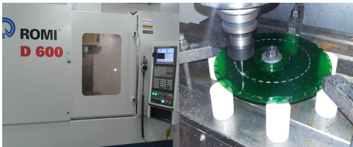
Figura 25 - Máquina CNC e fixação do disco para construção do protótipo
