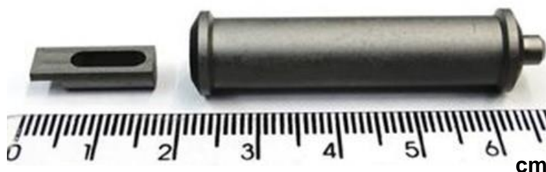
Figura 2. Plataforma e tubo de grafite pirolítico.
