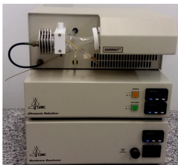
Figura 3. Nebulizador ultrassônico com sistema de dessolvatação.
