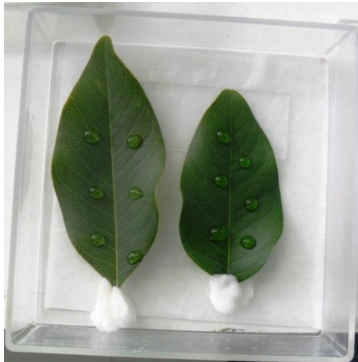
Figura 4 - Folíolos de Cassia fistula utilizados para o teste de patogenicidade com Colletotrichum sp., contendo o inóculo (100 \mu L), disposto em seis gotas sobre o limbo foliar, neste caso os folíolos não apresentavam ferimentos.
