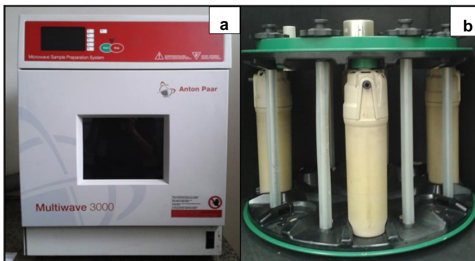
Figura 3. a) Forno de micro-ondas (Multiwave 3000 ® , Anton Paar) e b) rotor com os frascos de quartzo utilizados para a decomposição por MAWD e por MIC.
