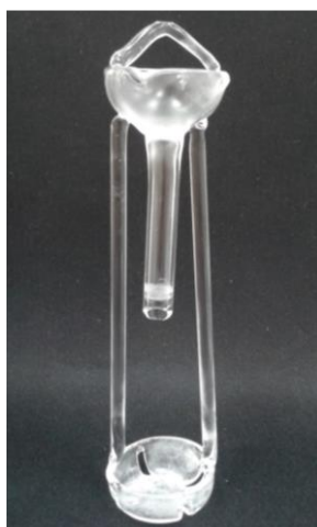
Figura 5. Suporte de quartzo utilizado para MIC.
