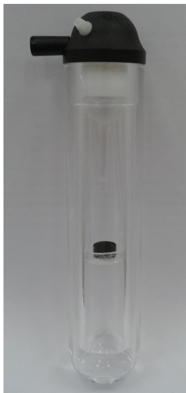
Figura 6. Comprimido de CNT na base do suporte de quartzo, no interior do frasco, para a decomposição por MIC.
