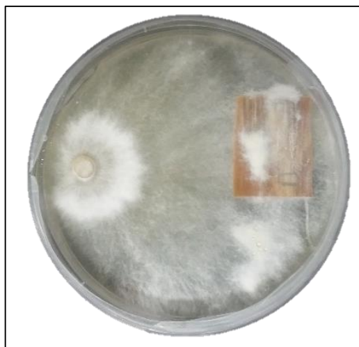
Figura 12 – Placa de petri representativa do ensaio de apodrecimento acelerado com Betula pubescens
