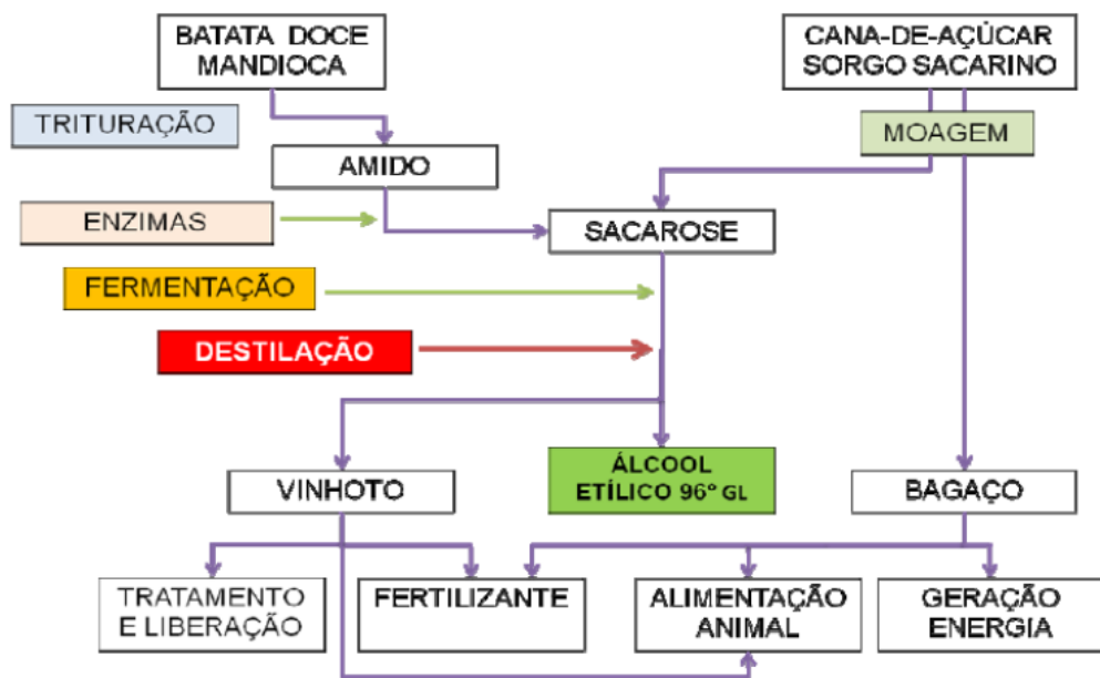
Figura 2 – Fluxograma de produção de etanol a partir de fontes amiláceas e sacarídeas.
