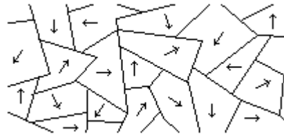
Figura 5.2 - Representação esquemática dos domínios magnéticos de um material ferromagnético. (Grupo de Ensino de Física, UFSM, http://www.ufsm.br/gef/Moderna26.htm , Acesso em 07/01/2010).
