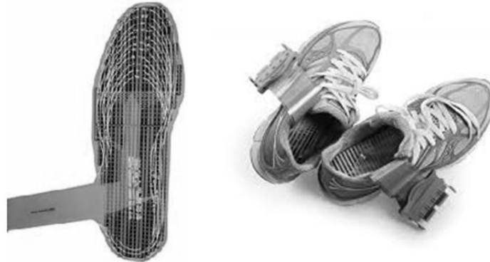
Figura 7 – Ilustração das palmilhas sensorizadas utilizadas na avaliação da pressão plantar (esquerda) e do posicionamento das palmilhas no calçado (direita)
