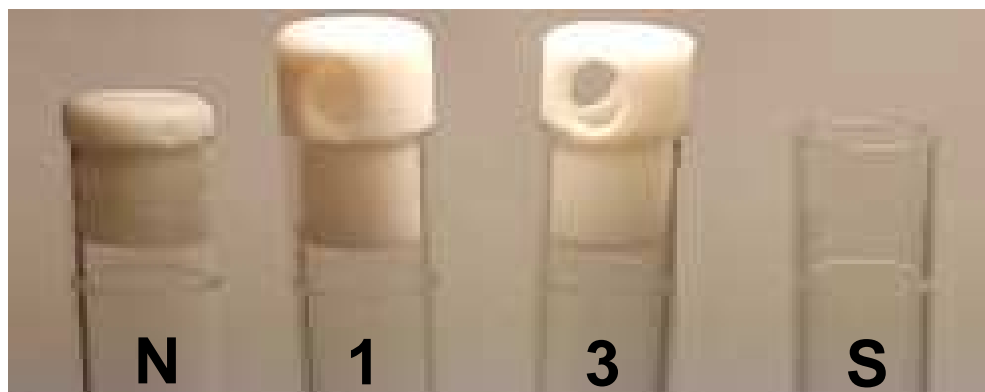
Figura 3. Tampas utilizadas na avaliação do sistema SRC. Sequência: (N) tampa normal; (1) tampa com 1 orifício; (3) tampa com 3 orifícios; e (S) sem tampa.
