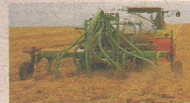
Distribuição de dejetos por injeção no solo
