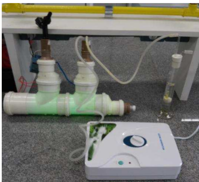
Figura 6 – Esquema de montagem do processo O_3/UV e detalhe do fotorreator construído
