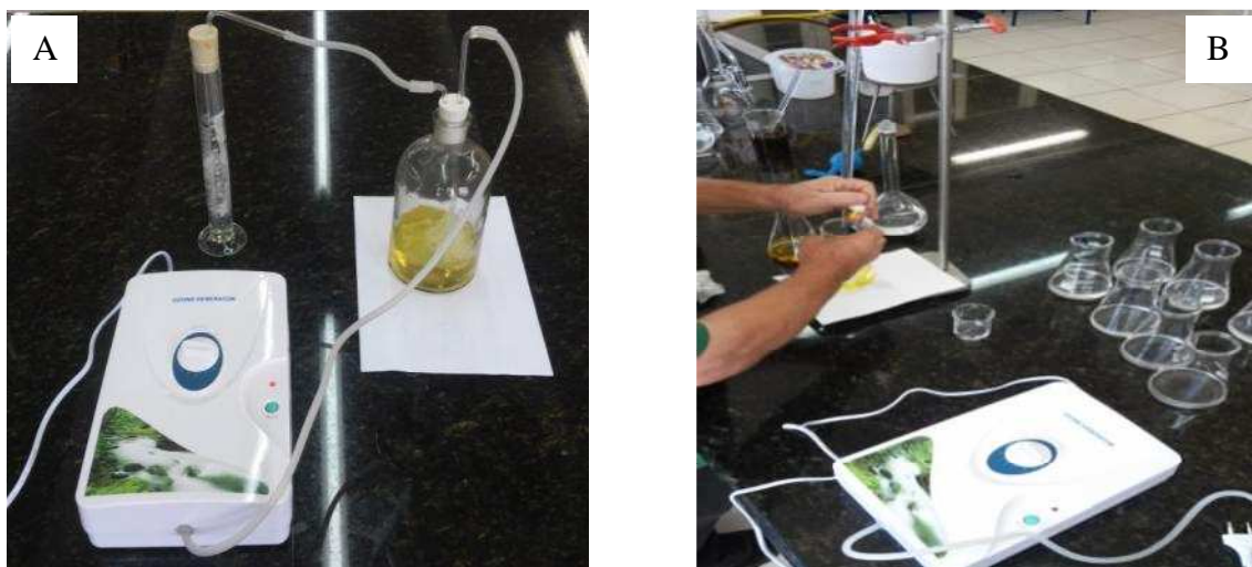
Figura 5 – Quantificação da geração de ozônio: A) Injeção de \text{O}_3 em solução de iodeto de potássio 2%; B) Titulação, da solução, com tiosulfato de sódio
