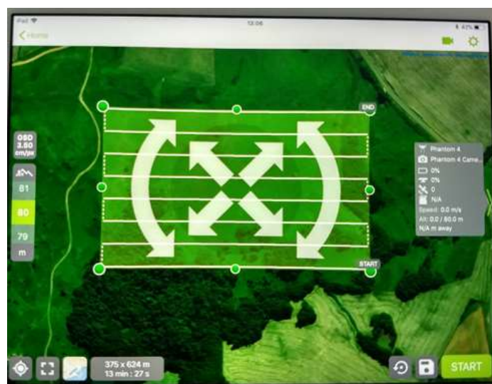
Figura 10 - Tela de visualização do plano de voo (polígono da área a ser sobrevoada) no aplicativo de gerenciamento Pix4D SA .
