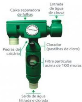
Figura 6: Equipamento de captura de água de chuva
