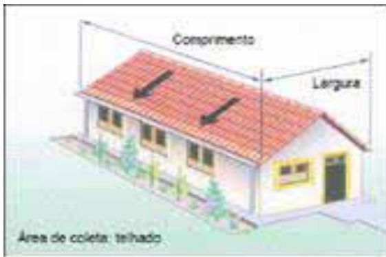
1) Telhado em duas águas
