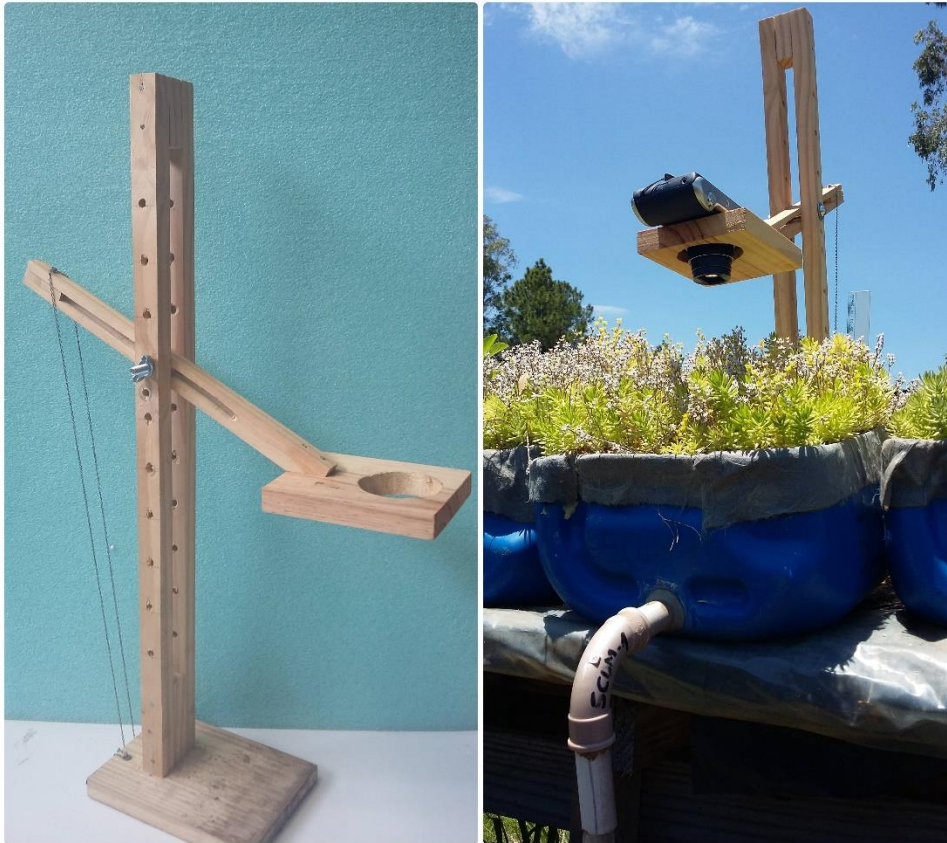
Figura 11 - Suporte em madeira utilizado para aquisição das imagens fotográficas
