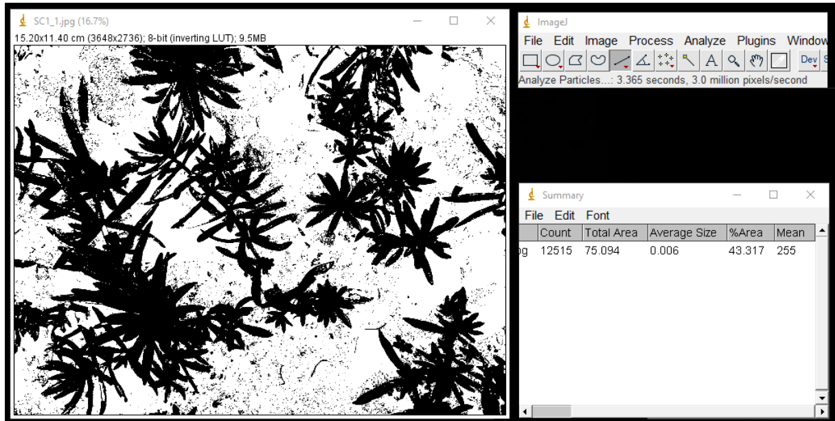
Figura 12 - Ilustração do layout do programa IMAGEJ® para quantificação da taxa de cobertura vegetal através da porcentagem de área coberta
