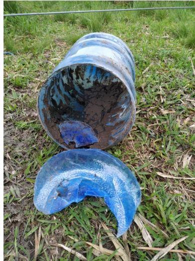
Figura 18 – Rompimento do biorreator devido a pressão interna gerada pelo biogás.
