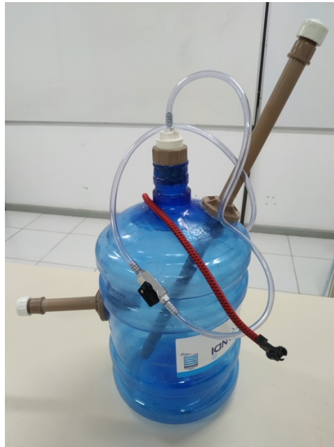
Figura 16 - Modelo de biodigestor de forma contínua.
