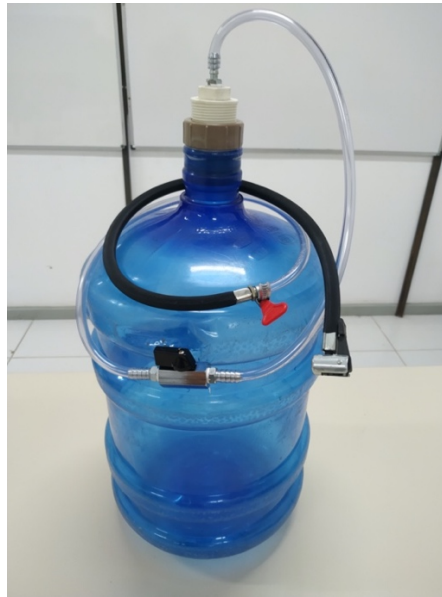
Figura 15 – Modelo de biodigestor por batelada.
