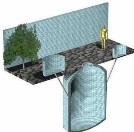
Figura 8 - Representação tridimensional em corte do biodigestor modelo Chinês
