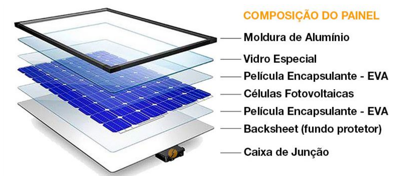
Figura 2.7 – Principais materiais de um painel
