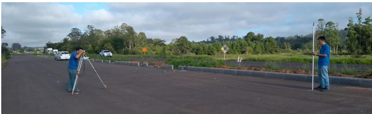
Figura 3.19 – Levantamento do perfil de referência com nível e mira
