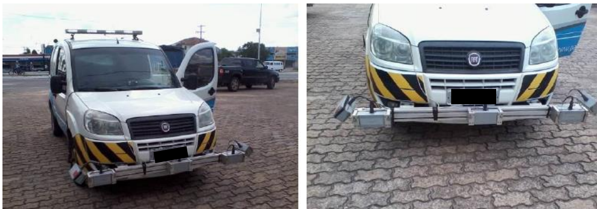
Figura 3.16 – Perfilômetro Inercial da Pavesys Engenharia
