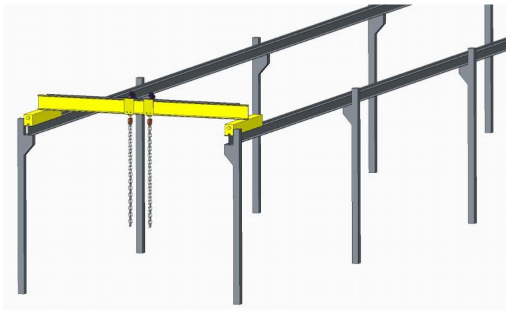
Figura 33 - Conjunto completo da ponte rolante apoiado sobre os trilhos.
