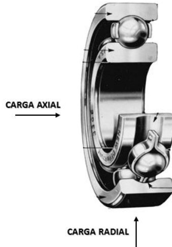
Figura 22 – Direcionamento da força axial e radial
