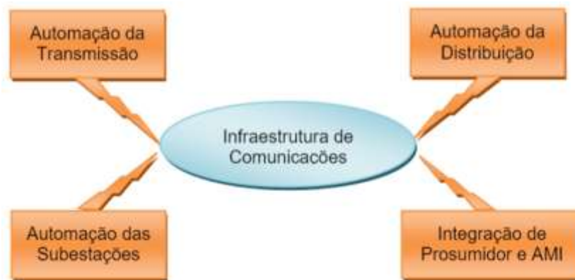
Figura 3 – Comunicações em Redes Elétrica Inteligentes
