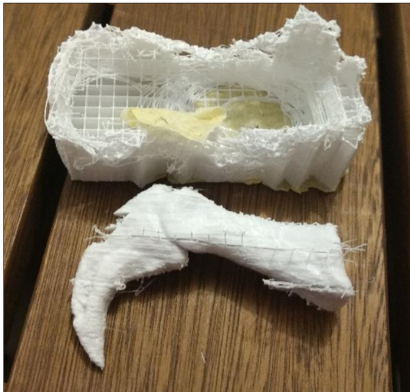
Figura 25 - Objeto retirado do suporte, com rebarbas de filamento PLA
