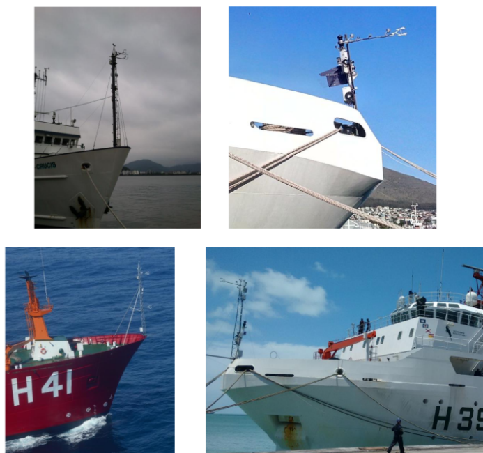
Figura 3.2 – . Navio Oceanográfico Alpha-Crucis (superior - esquerda), Navio de Pesquisa Hidroceanográfico Vital de Oliveira (superior - direita FORSA e inferior - direita PIRATA) Navio Polar Almirante Maximiano (inferior - esquerda) com as torres micrometeorológicas instaladas em suas proas.
