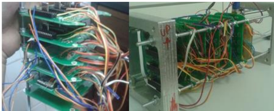
Figura 6 - Montagem dos módulos espaçados (á esquerda montagem das placas, á direita estrutura do gabinete).
