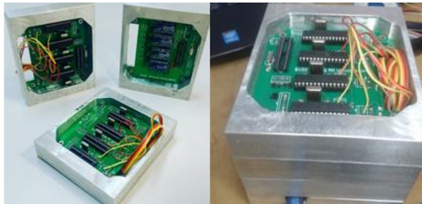
Figura 5 - Camadas dos módulos do coletor de dados (á esquerda módulos individuais, á direita montagem).
