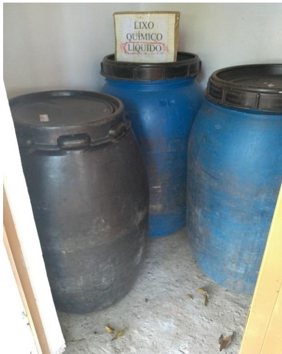
Figura 7 - Bombonas de 200l para armazenamento dos resíduos na Unidade B.
