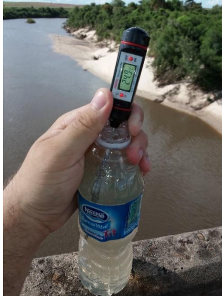
Figura 7 - Coleta da temperatura da água diretamente no ponto amostral.
