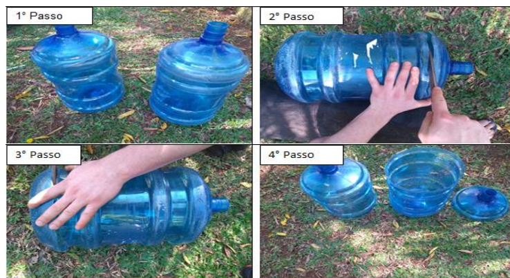
Figura 3 – Etapas de cortes das bombonas plásticas para confecção da composteira doméstica.
