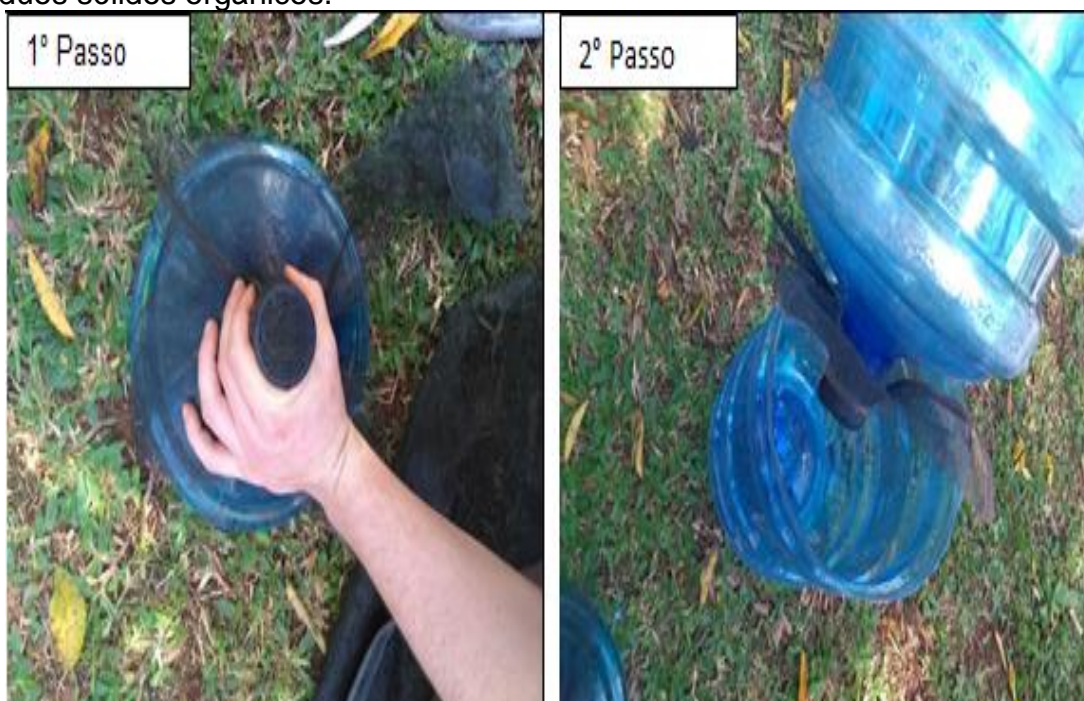
Figura 4 - Implantação da tela no bocal da bombona para impedir a saída dos resíduos sólidos orgânicos.
