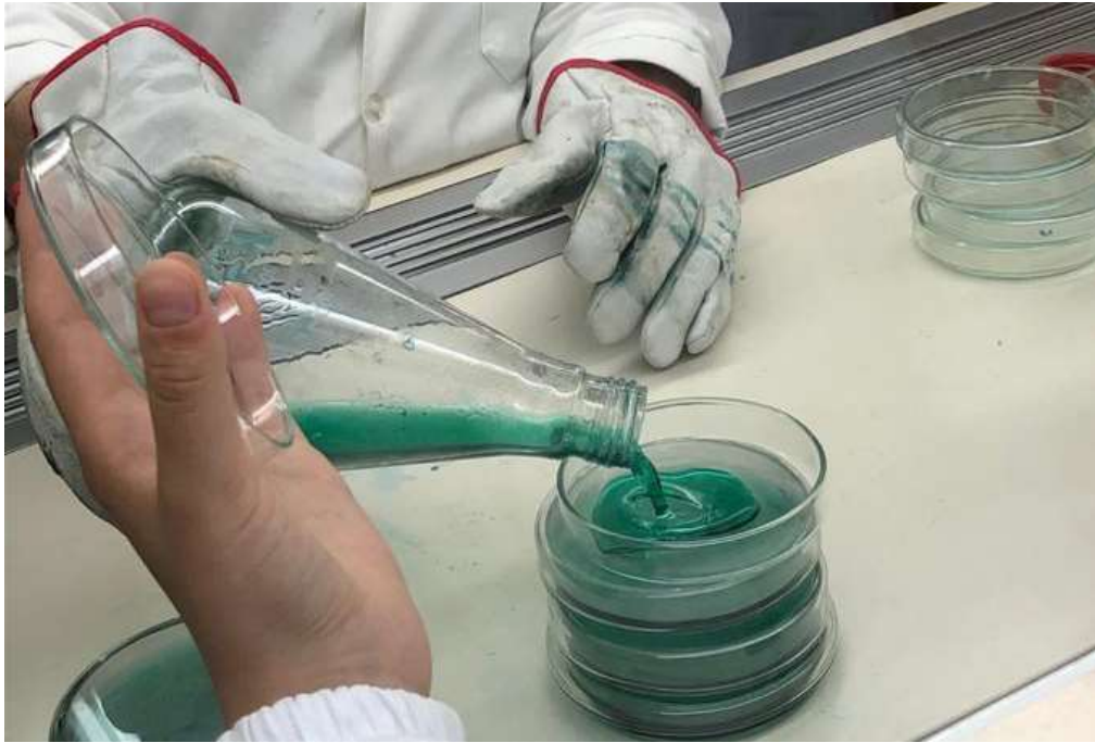
Figura 3 - Preparação das placas de Petri para teste Killer e sensibilidade com mosto 80:20
