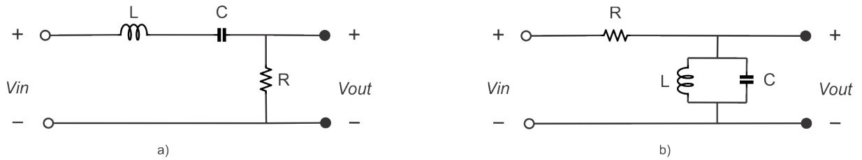
Figura 2.13 – Filtro passa-faixa: em a), configuração série e em b), configuração paralelo
