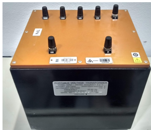
Figura 2.25 – Transformador de Potencial Yokogawa ®
