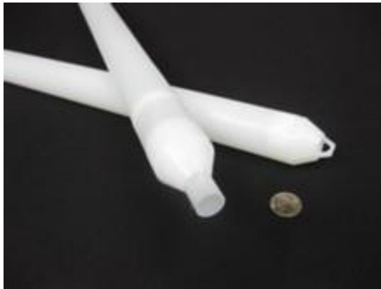
Figura 9: Equipamento de auxílio (Bailer) utilizado na coleta de água do efluente final (P4) dos viveiros.
